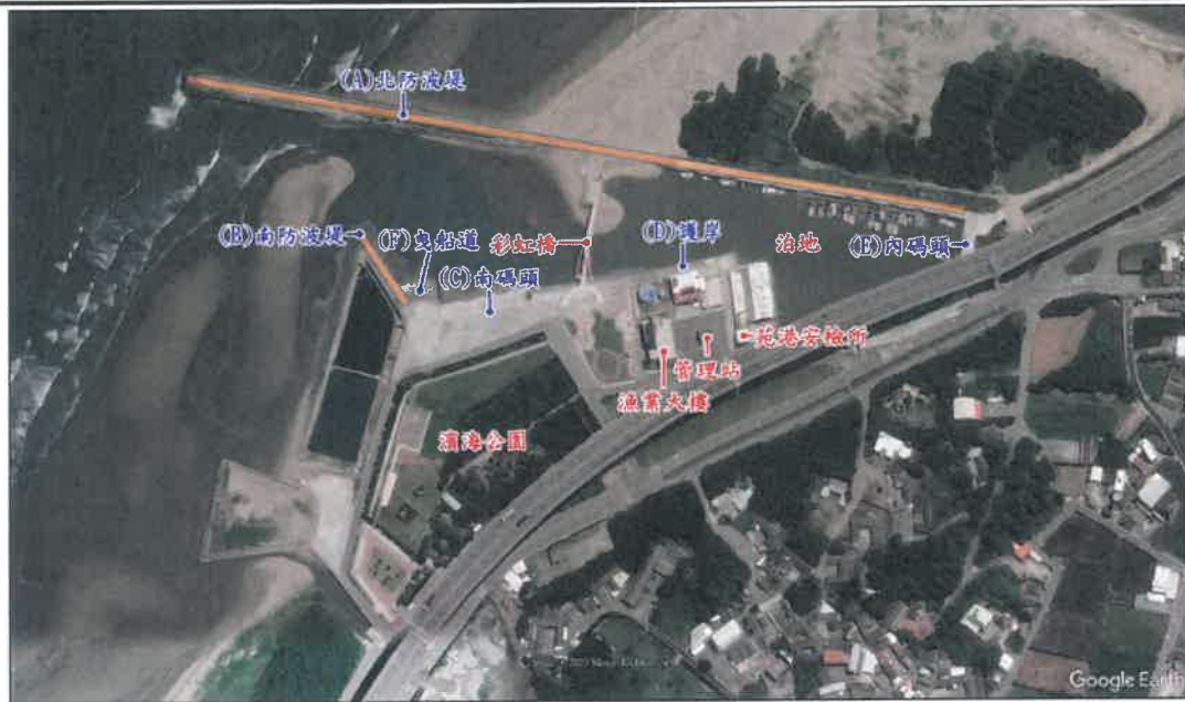
圖 3 苑港漁港堤岸防護設施區位圖
